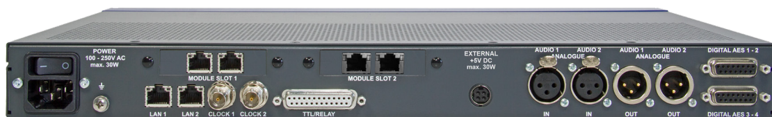
MAGIC THipPro VoIP с опцией LAN3/4 и модулем Dante
